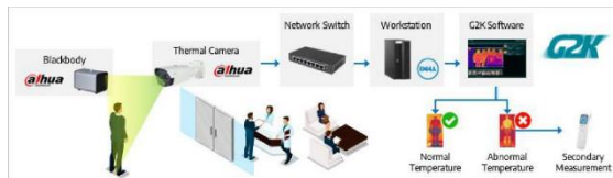
Abbildung 3: Systemaufbau G2K „Fever Scanner“
